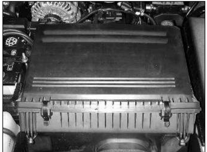
n. Remove the airbox.
